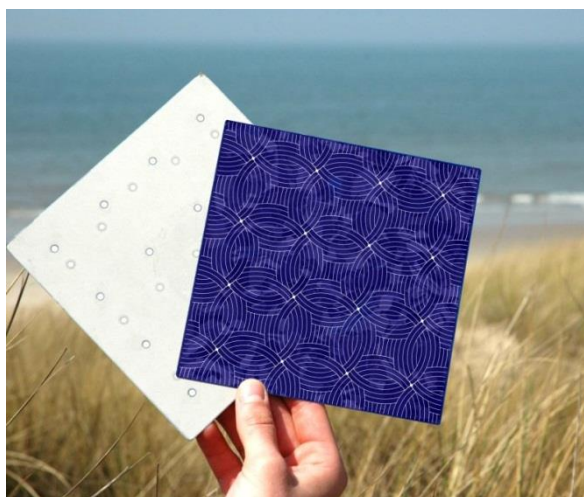
Voorbeeld van een backcontact zonnecel
